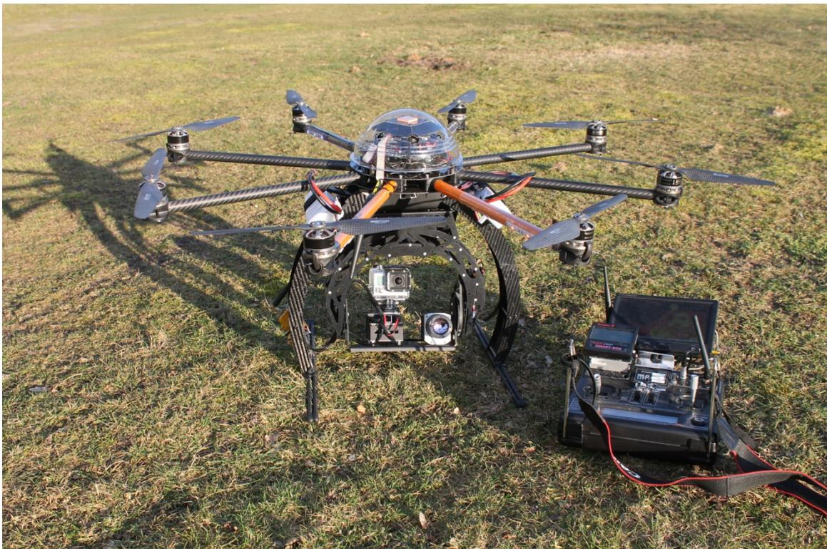
Abbildung 5Oktokopter mit Fernsteuerung
