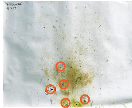
**Ergebnis auf der Wiese:** Von insgesamt acht Schüssen sausten bei fünf Reste oder auch ganze Geschosse hinter dem Kugelfang durch die Scheibe.
