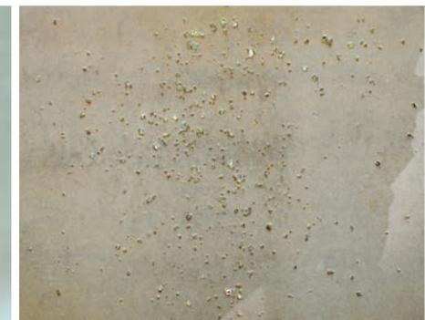
**Durchlöchert:** die Fangscheibe nach 24 Schuss. Alle Löcher sind Abpraller, die großen oben schlugen unten ein – die Scheibe wurde zwischenzeitlich gedreht.
